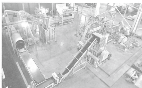
A級フレークに再資源化するペットボトルリサイクルシステム（投入量約1t/時）
