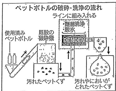
既設の破碎ラインに組み入れて輸出できる状態に洗浄する
